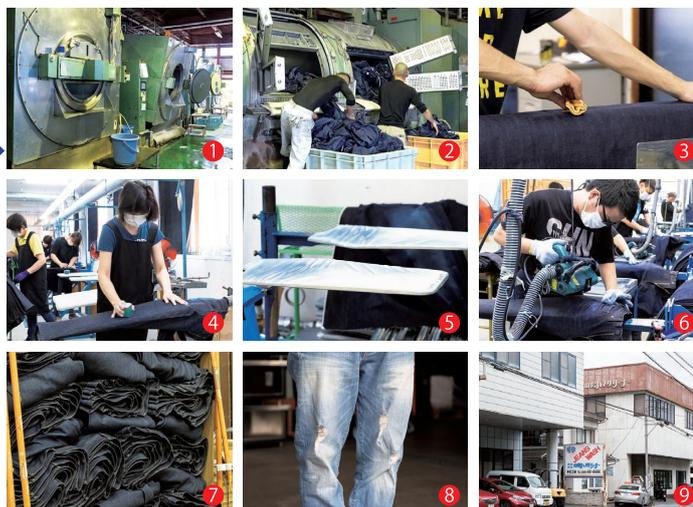
①②ウォッシュ加工。ずらりと並ぶ巨大な洗濯機は圧巻！③薬品を用いてダメージ加工を施します。④⑤特製ヒゲ板を使い、ジーンズの内もも部分に履きジワ・通称ヒゲをリアルに再現。⑥表面をシェービングしてユーズド感を出します。⑦⑧加工前のジーンズと、様々な加工に加えしっかり履き込まれたジーンズ。⑨本社工場。
